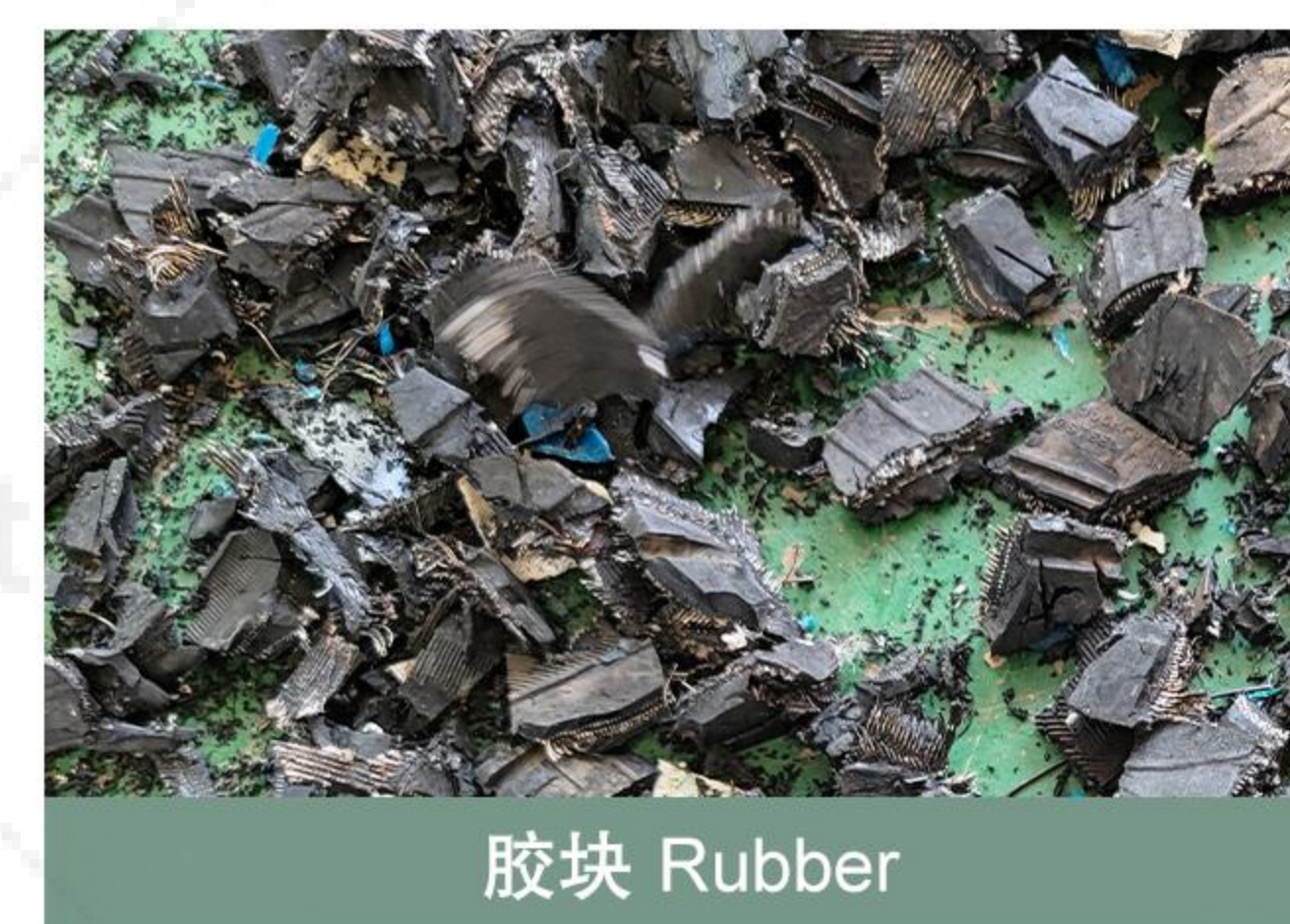
钢丝分离机 胶块细破碎，分离出细钢丝
