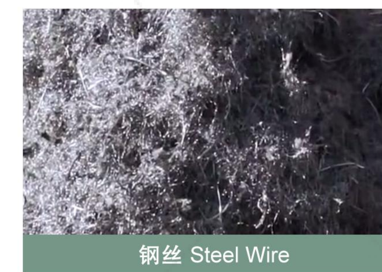
磁选机 永磁除铁器，分选出细钢丝
